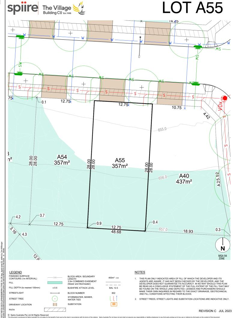
FINISHED SURFACE CONTOURS (1m INTERVAL)
